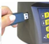
El **REI IN-2** posee un conector USB, que permite realizar la descarga de los datos con un pendrive, esto permite usarlo y colocarlo en cualquier lugar sin la necesidad de tener un vínculo de conectividad fijo como ser un obrador.
