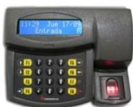
Compacto, robusto, de fina terminación, de moderno diseño y con teclado para programación incorporado. El gabinete del equipo está diseñado a partir de una pieza inyectada en plástico ABS de alta resistencia y con paredes de 6 mm, marcando una gran diferencia con la mayoría de los productos disponibles en el mercado. Único en su clase por su robustez, ideal para resistir el maltrato y/o situaciones vandálicas.
