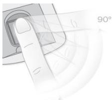
El sensor del **REI IN-2** está diseñado para obtener una lectura precisa y rápida, mediante métodos ISO, inclusive si la huella no se encuentra ubicada exactamente en la posición de enrolamiento. Esto quiere decir que el equipo leerá la imagen de la huella, aunque ésta se encuentre rotada a izquierda o derecha hasta 90° según la configuración inicial realizada por el usuario.
